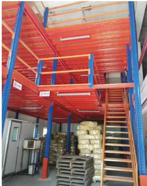
轻型货架结构：货架立柱：由等边角钢双边冲孔制成，孔距离以50mm距离沿直线排列，立柱孔用来挂接层板之用；货架钢层板：采有冷轧钢板按所需尺寸四边折弯成型。立柱与钢层板通过速扣卡销和三角型固定片连接与固定组成的货架。货架各部件加工好成型之后全部经打磨>酸洗磷化>全自动粉末静电喷涂>烘干等工艺处理后组装成品。生产出的货架成品表面光洁、美观；层板可上下任意调节，拆装方便。轻型货架特点：全组装式结构，随意组合、安装、拆卸方便灵活。货架材料截面优化，多种管材选择，提高承载力。层板有木板和钢板可供选择，立柱高度设有每50mm调节孔距，可根据货物高低调节层间使用。云浮家用仓储货架厂诚信是企业生存和发展的根本。
